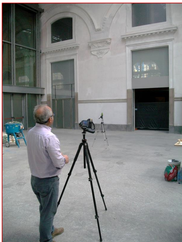
Fase di indagine termografica e di riscaldamento dell’ambiente con termoconvettore mobile.
