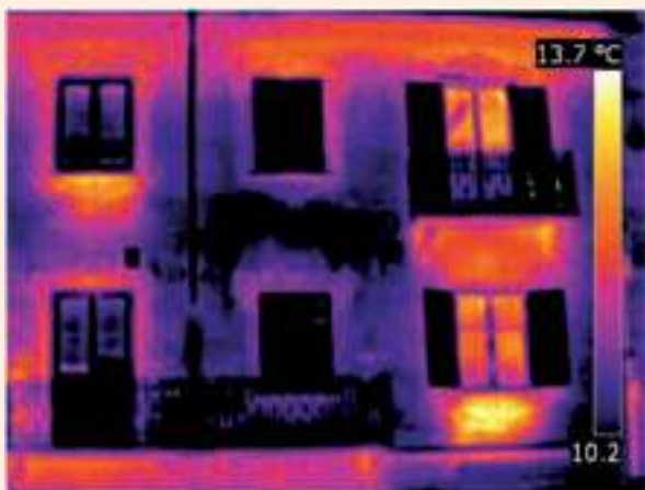
Dispersioni termiche sotto finestra e volini
